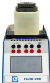
I Fluid con il diametro del pozzetto di 60mm possono essere corredati di un tubo d'estensione per aumentare l'immersione totale a 230 mm
