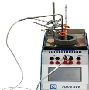
I Fluid sono provvisti di supporti regolabili per sostenere le sonde in prova o termometri in vetro.
