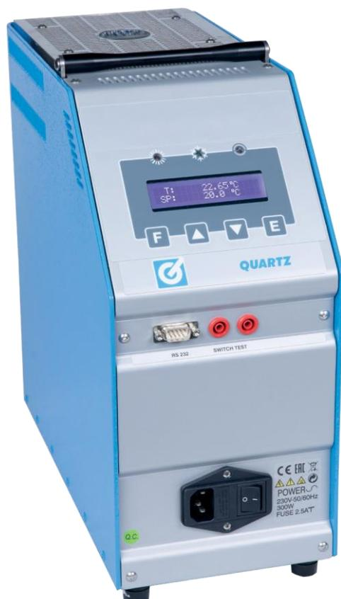
Il **QUARTZ 633** ed il **QUARTZ 50** sono dei calibratori di temperatura portatili e compatti per controlli in laboratorio ed in campo di sensori di temperatura, termocoppie e Pt100. Sono provvisti di un blocco in anticorodal con un foro di diametro 35 mm e profondità 135 mm nel quale vengono alloggiati gli inserti di riduzione; l'intercambiabilità dell'inserto rende possibile il collaudo di sensori di varie lunghezze e diametri.
